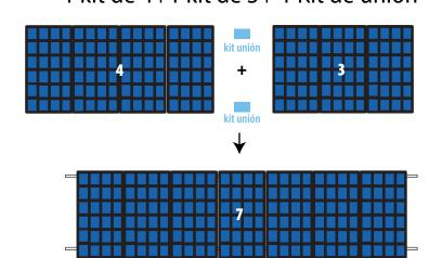
Para realizar una fila de 10 módulos se realizaría con 1 kit de 4+1 kit de 6+ 1 Kit de unión
